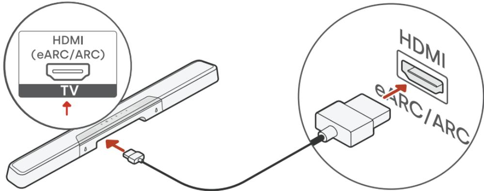
1. Suchen Sie an Ihrem Fernseher nach dem HDMI-Anschluss mit der Bezeichnung „ARC“ oder „eARC“. **WICHTIG:** Nur ein Anschluss an Ihrem Fernseher ist mit „ARC“ oder „eARC“ beschriftet. Sie müssen genau diesen Anschluss für die Verbindung verwenden, da Sie sonst keinen TV-Ton hören können.
